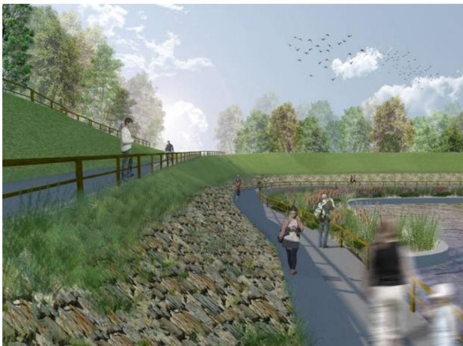
**Figura 4-9 – Fotoinserimento che illustra la conformazione delle sponde della vasca**
