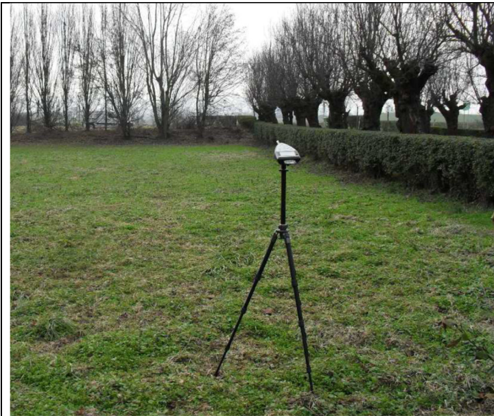
Esempio di fonometro che si userà nel monitoraggio acustico
