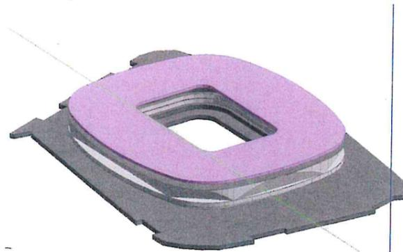
Fig.12: Costruzione del modello geometrico dello stadio con Design Builder all'interno del software di simulazione energetica Energy Plus
