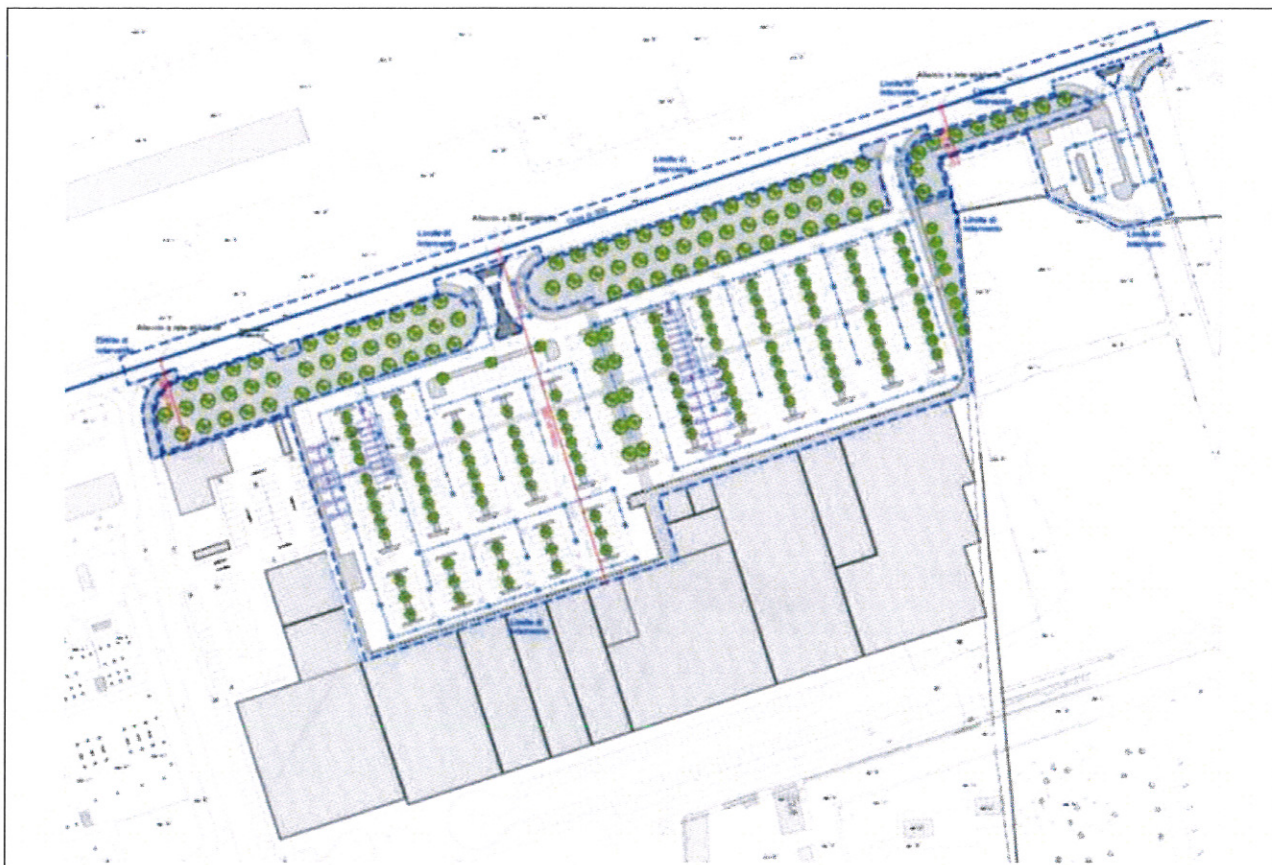
Figura 2.16: tracciato collettore fognatura nera esistente e schema della rete interna al PII
