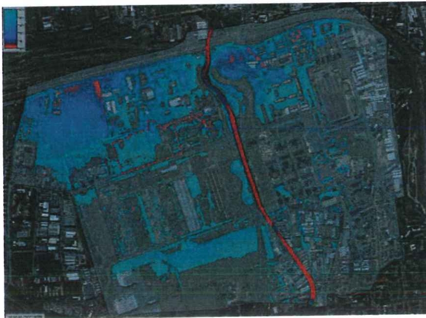
Aree soggette ad allagamento al termine dell'evento considerato.
